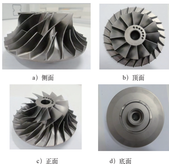
图2 喷丸后离心叶轮表面宏观照片
