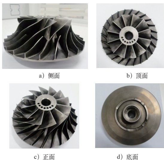
图1 喷丸前离心叶轮表面宏观照片
