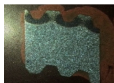
图2 根部硬化层深1.05mm
