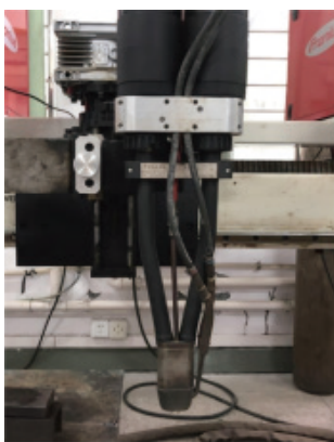
图2 福尼斯Time twin焊枪 [16]
