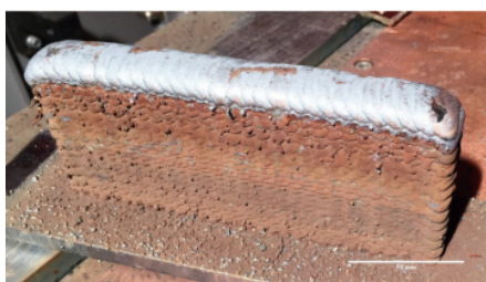
图7 振荡打印路径所成墙体
