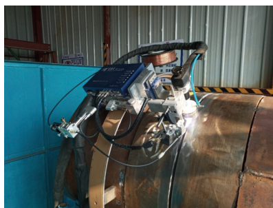
图7 TIG自动焊不预热后热的焊接工艺评定试验
