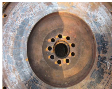
图2 不均匀摩擦和裂纹
