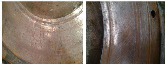
a) 飞轮摩擦面裂纹 b) 飞轮摩擦面表面沟壑
