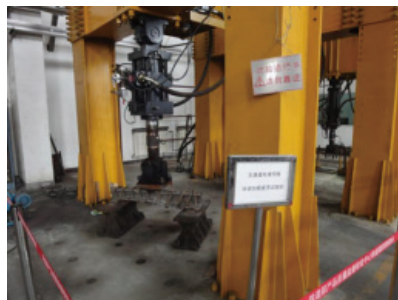
图6 60AT1-75锻压跟端疲劳试验现场
