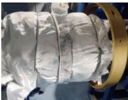
b) 布置实物 图1 热电偶、加热片布置
