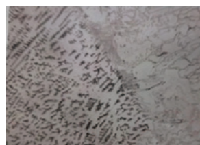
图6 1.4507侧熔合线附近显微组织
