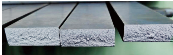
c) 20CrMnTi钢扭力杆断口宏观形貌
