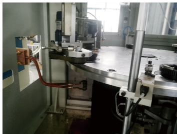
图8 气门杆部多圈单孔淬透自动淬回火感应器（六工位）
