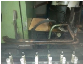
图7 气门杆部淬透连续淬火感应器
