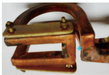
图13 气门杆端淬火感应器2（缩小五角星位置的距离）
