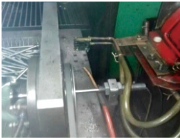
图6 气门杆部手动冲击/仿形淬火感应器
