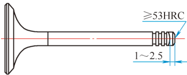
图4 气门杆端冲击淬火
