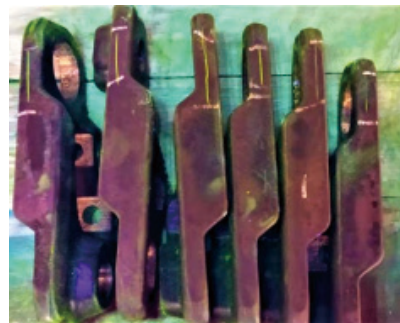
图4 裂纹宏观形貌
