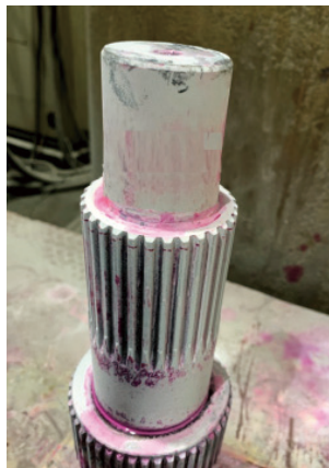
图5 着色检测裂纹
