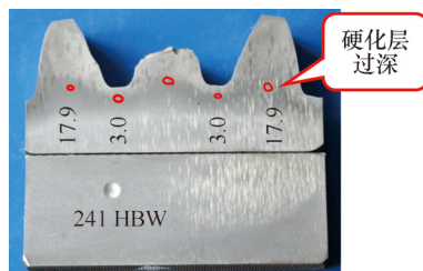
a) 断齿部位硬化层
