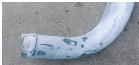
图1 高压空气不锈钢管渗透检测结果
