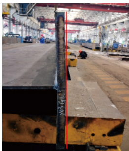
图9 翼缘弯曲角变形示例
