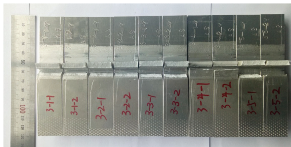
图7 不同旋转速度SSFSW的T形接头沿筋板方向拉伸断裂表面宏观形貌
