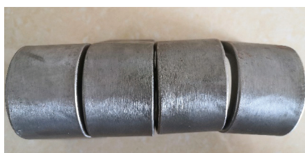
图6 试件侧弯受拉面
