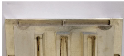
图7 某航空散热器合格产品的表面宏观形貌
