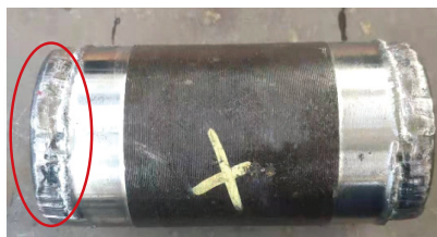
图1 20CrMnTi销套硬度不良拆解后外观
