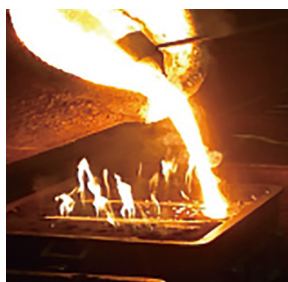
图1 排气管浇注过程的排气
