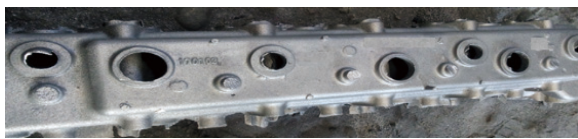
图4 更改工艺孔后制作合格铸件
