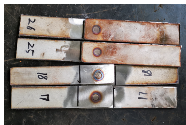
a) 电阻焊试件
