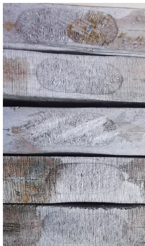
图10 电阻焊接头断面宏观金相
