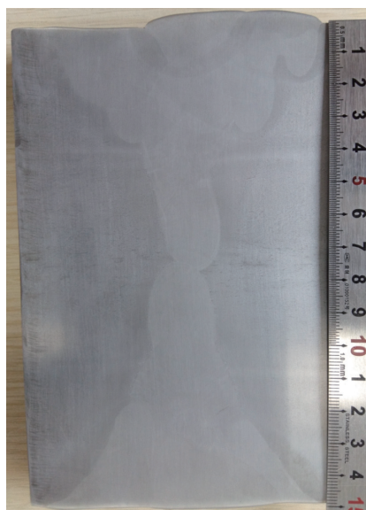
图7 150mm+150mm接头宏观金相
