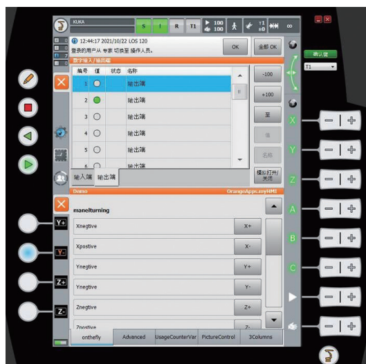
图8 焊接路径实时调整界面
