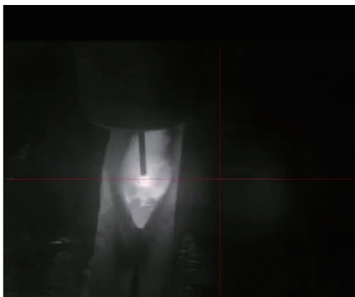
图4 电弧摄像焊缝中心
