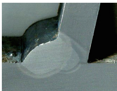
图9 双丝混合焊U肋焊缝宏观金相
