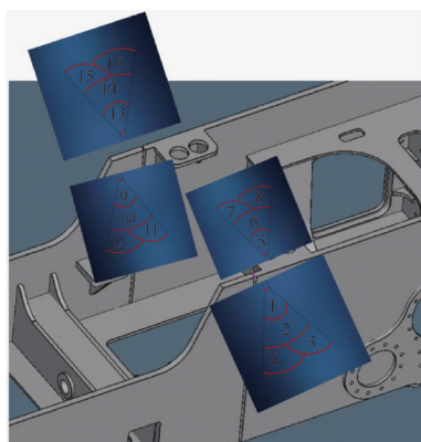
图2 车架断开结构及焊缝形式示意
