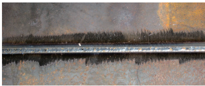
图2 焊缝背面成形
