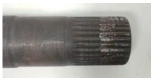
图12 半轴经30.80万次疲劳试验后花键处磨损
