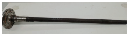
图11 半轴经30.45万次疲劳试验后样品完好
