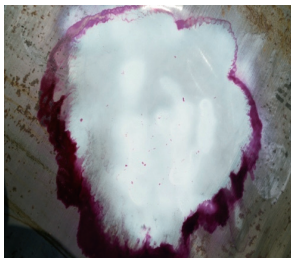
图3 着色检测开口缺陷
