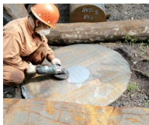
图2 支承辊中心部位打磨
