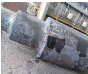
图1 存在缺陷支承辊
