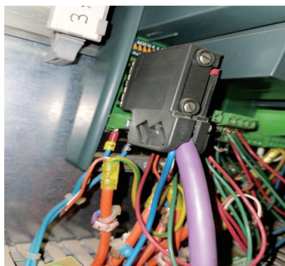
图6 西门子PROFIBUS-DP接头
