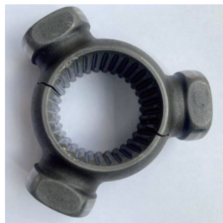
图1 断裂三销架宏观形貌
