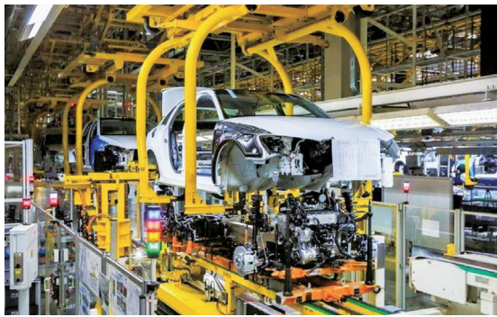
图 3 某主机厂举升机举升底盘式合车
