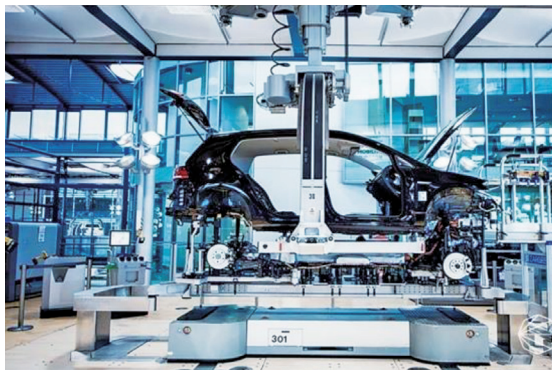
图 4 某主机厂车身吊具下降式合车
