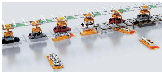
图 5 AGV 输送整体式合车示意
