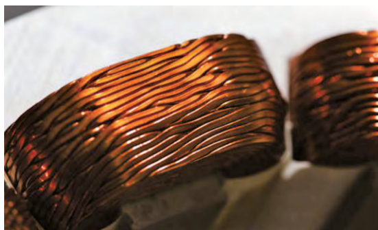
图 1 AEM 公司使用铝绕组替代铜，轻量化使得电机速度达到 30 000 r/min
