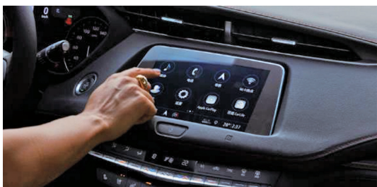
图 1 背面与仪表板饰板平面完全贴合的显示屏
