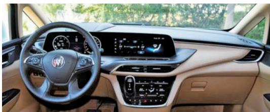
图 2 突出于仪表板表面的显示屏
