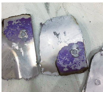
图5 铝点焊虚焊、焊核小
