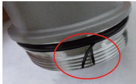
图 3 高压滤清器盖啃伤实物
