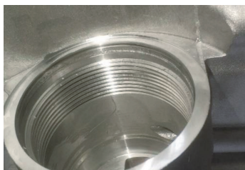
图5 高压滤清器盖划伤壳体实物
