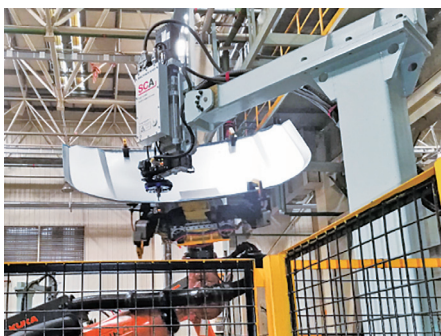
图2 涂胶检测监控
