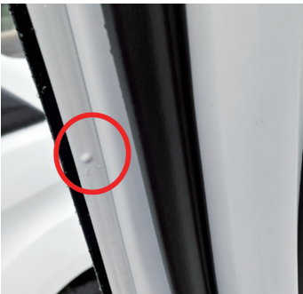
图 1 某车的车门胶泡
