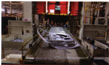
图2 皮带破损老化
