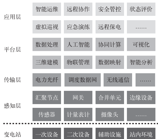
图2 数字孪生变电站系统架构
