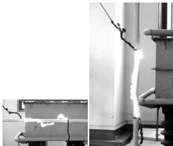
图5 绝缘杆水平和垂直布置工频放电试验
