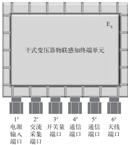
图4 智能物联终端箱体结构示意图
