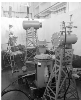
图 14 MR 分接开关加装 QPRD 的防爆泄压试验
