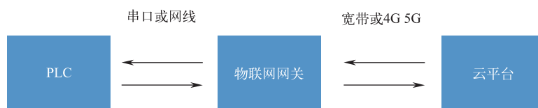
图2 PLC与云平台通信示意图
