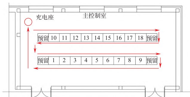
图10 主控室巡视路线
