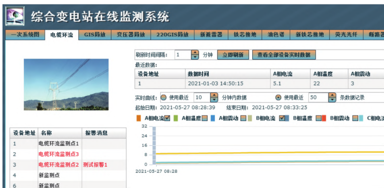
图8 上位机电缆环流显示页面
