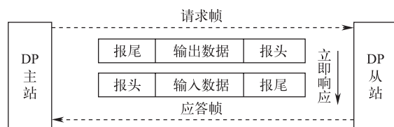
图6 Profibus DP报文通信的基本顺序
