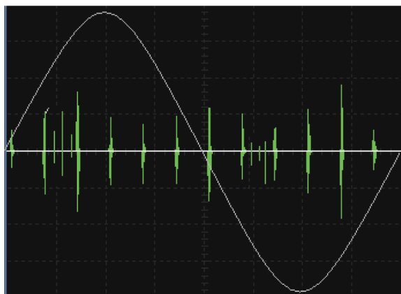
图5 消除干扰前测量的局放信号
