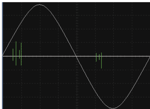
图6 消除干扰后测量的局放信号
