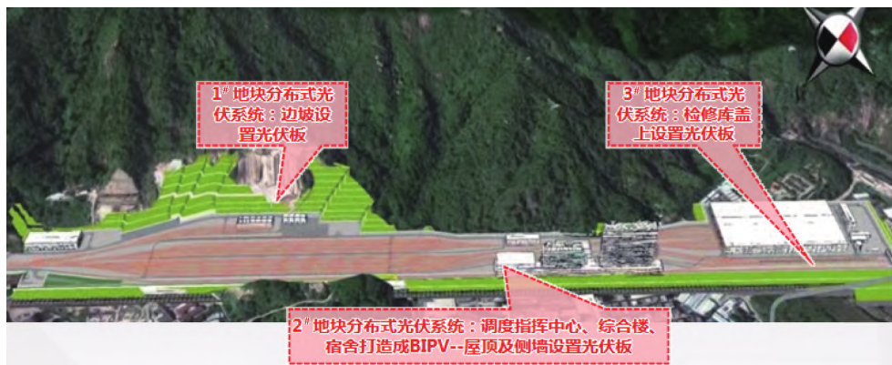
图4 九围车辆基地光伏发电分布图
