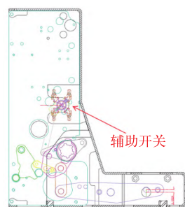
a) 合闸保持状态辅助开关位置
